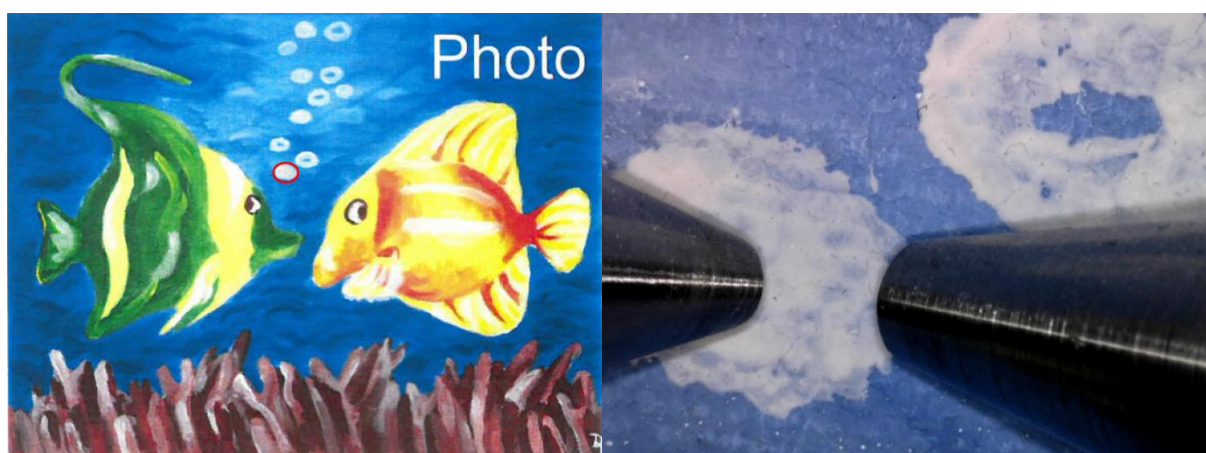
Obr. 24. Vlevo: fotografie celého obrázku dvou rybek. Vpravo: detailní fotografie analyzovaného bodu, nacházejícího se uprostřed konců primární (napravo) a sekundární (nalevo) polykapilární optiky.
